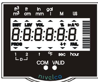
Dugaszolható kijelző egység
